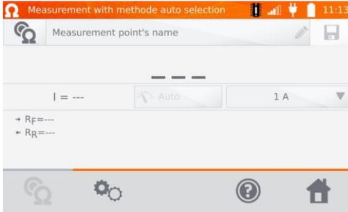
Wird eine Induktivmessung ausgewählt und während der Messergebnisstabilisierung ein Unterschied zwischen dem Momentan- und Durchschnittswert des Ergebnisses ermittelt, erkennt das MMR-650 automatisch das ohmsche Objekt und schließt den Messvorgang schneller ab.
