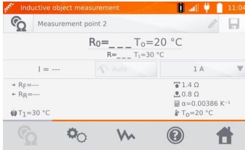
8 Verbinden Sie das Messgerät mit dem Messobjekt, um mit **START/STOP** die Messung zu starten.
