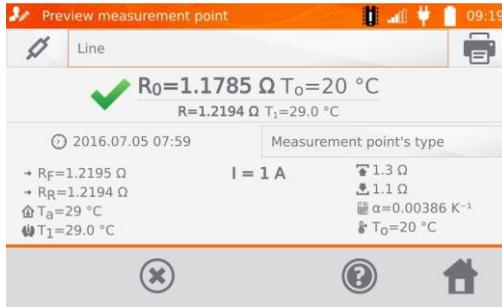
Der Ausdruck enthält alle Ergebnisse und Messparameter, Beurteilungen (positiv und negativ), das Datum und die Zeit der Messung und Informationen zum Prüfer, den Druckeinstellungen entsprechend.
