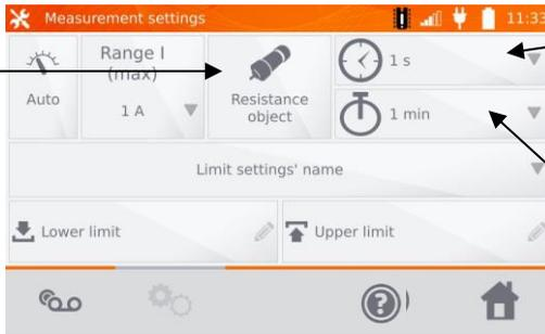
Auswahl der Zeitintervalle: 1 s, 5 s, 10 s, 15 s, 1 min, 5 min, 10 min, 15 min
