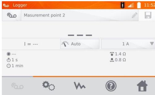
7 Verbinden Sie das Messgerät mit dem Prüfobjekt und starten Sie die Messungen mit **START/STOP**.
