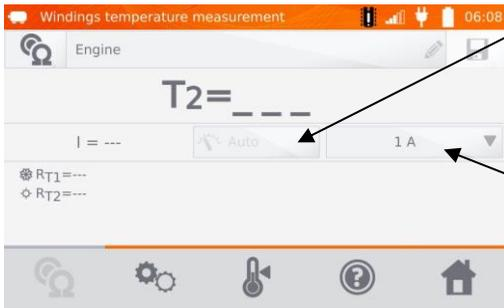
Das Einstellen des Messstromes ist für diese Messung nicht möglich und steht immer auf **Auto mode**.
