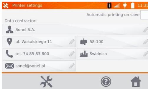
Die zur Auswahl stehenden Felder können mit individuellen Firmendaten oder Angaben zum Prüfer ausgefüllt werden. Diese werden später auf dem Ausdruck übernommen. Das automatische Drucken nach dem Speichern ist verfügbar.
