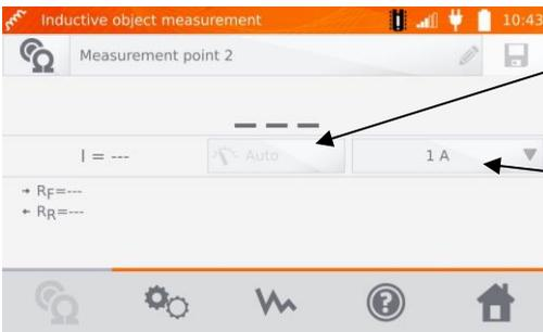
Zur Messung von induktiven Objekten ist nur der **Auto Modus** verfügbar – der Messstrom wird auf den eingestellten Wert begrenzt.
