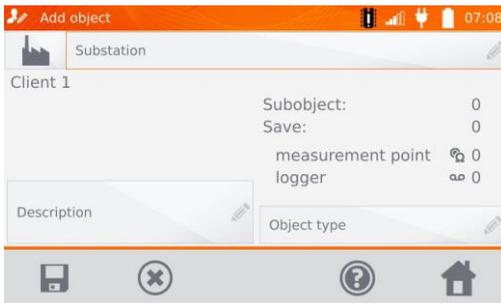
Es kann eine zusätzliche Beschreibung des Objektes über die Auswahl **Description** hinzugefügt werden. Der **Object type** kann ebenfalls mit einer Standard- oder individuelle Bezeichnung versehen werden.
